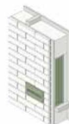
Vleermuiskasten in de gevel
