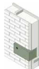
Huismuskasten in de gevel
