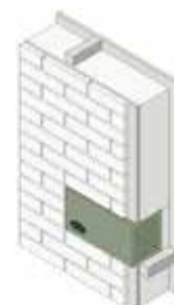
Nestkast in de gevel
